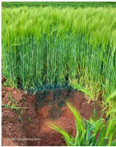
Bild: Mit einem Farbstoff werden die Fließwege des Sickerwassers im Boden sichtbar.
