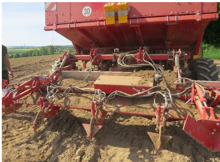
Werkzeuge zur Anhäufung des Querdamms, Foto: K. Großner, LfULG
