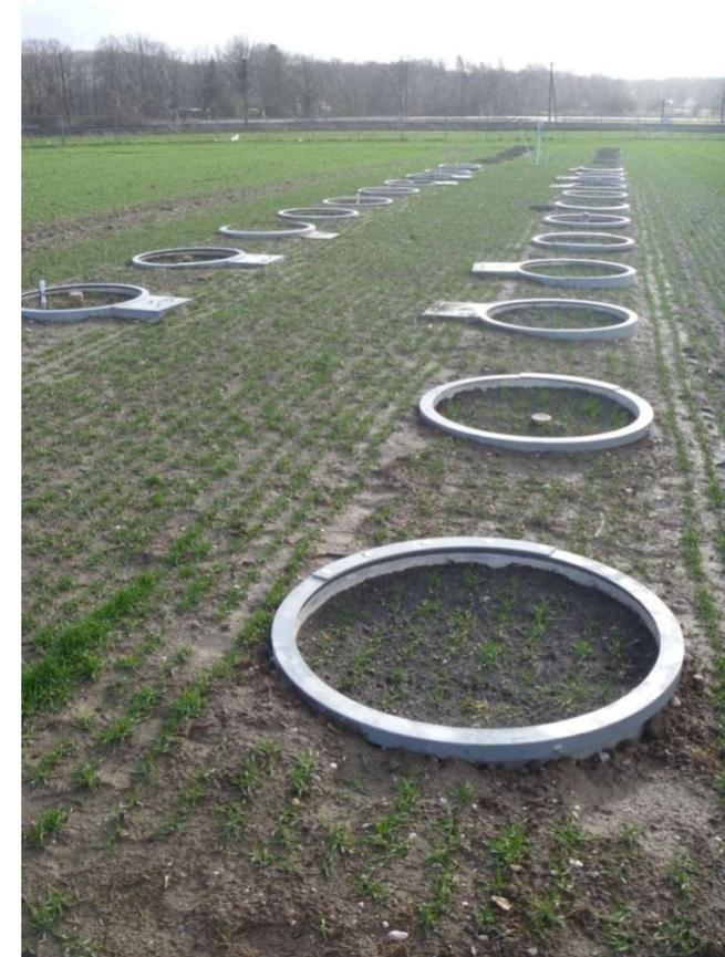
**Abb. 4:** Blick über das Lysimeterfeld mit Lysimetern im Vordergrund und Versickerungsmessern im Hintergrund
