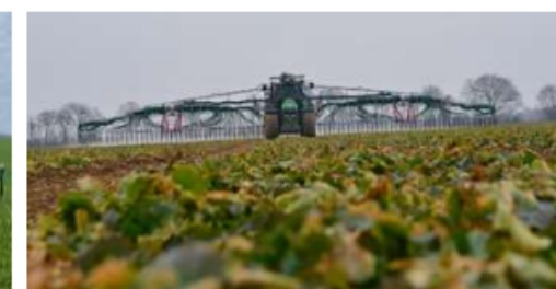
Abb. 2: Bei Nutzung der Fahrgassen wird eine Verdichtung des Bodens im mehrfach überrollten Bereich in Kauf genommen (Quelle: Närmann-Peitzmeier GbR)
