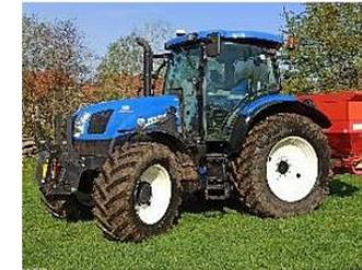
Schutzkategorie 2: Schutz gegen Staub; Belüftungs- & Filtersystem mit Möglichkeit zum Filtereinbau, entweder Überdruck von 50 Pa in Kabine oder 20 Pa mit zusätzlicher Druckanzeige sowie eine Frischluftzufuhr von min. 30 m³/h
