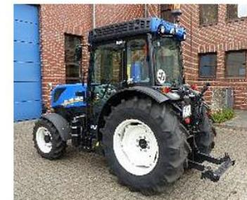
Schutzkategorie 4: Schutz gegen Staub, Aerosole und Dämpfe; Anforderungen wie in Kategorie 3; zusätzlich >98% Schutzniveau bei Aerosoltest
